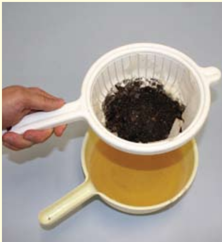
Hình 10.23 Bộ dụng cụ khay Whitehead để tách tuyến trùng
